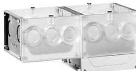
Les boîtes REDDY sont dotées de 12 entrées défonçables de diamètre 20 mm dont 6 avec épaulement, et 2 grandes entrées latérales en profondeur 65 mm.
