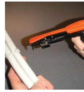
3. De kabelbinder aanspannen tot de gewenste spanning en bundeling is bekomen, de kabelbinder wordt automatisch afgeknipt.
