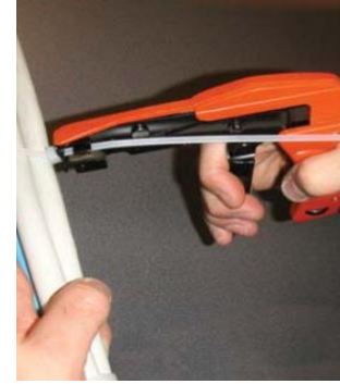
3. De kabelbinder aanspannen tot de gewenste spanning en bundeling is bekomen, de kabelbinder wordt automatisch afgeknipt.
