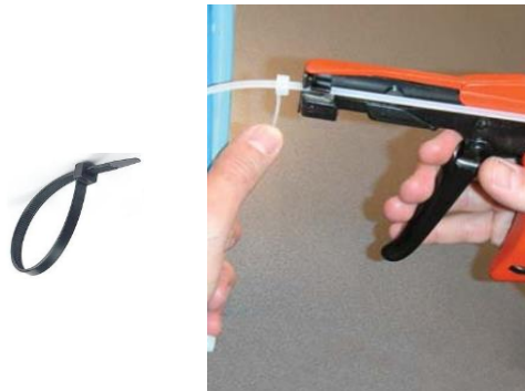
2. Het uiteinde van de kabelbinder met de tang vastnemen.
